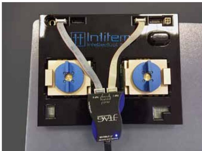
**Рис. 8.** Устройство EG-X7VX1140-1930 компании «ИнжГрупп» для входного контроля микросхем XC7VX1140T-1FLG1930I
