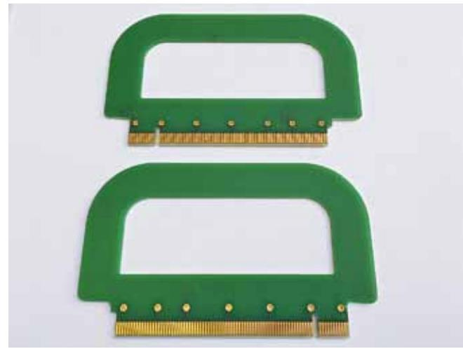
**Рис. 5.** Платы-заглушки для прозвонки межсоединений ПЛИС
