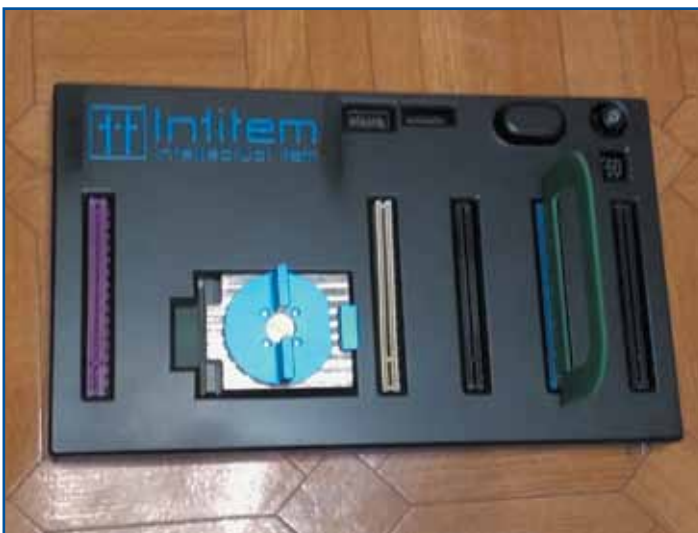
Рис. 1. Плата для тестирования ПЛИС Xilinx EG-X7V690-1157
