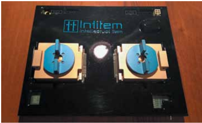
Рис. 3. Плата для тестирования ПЛИС Xilinx EG-X7V1140-1930
